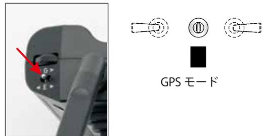
GPS信号は、天候、環境およびその他の要因を含む干渉の影響を受けやすく、GPSモードの精度に影響を与える可能性があります。もしGPSモードで挙動が不安定だった場合、一度着陸させ、衛星の数が10以上であることを確認してください。
