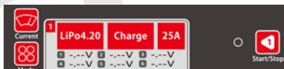
「Current」ボタンと「Mode」ボタンを同時に 3 秒押すと、バッテリー種類を切替できます。
