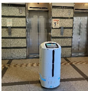
エレベーター呼び出し中
