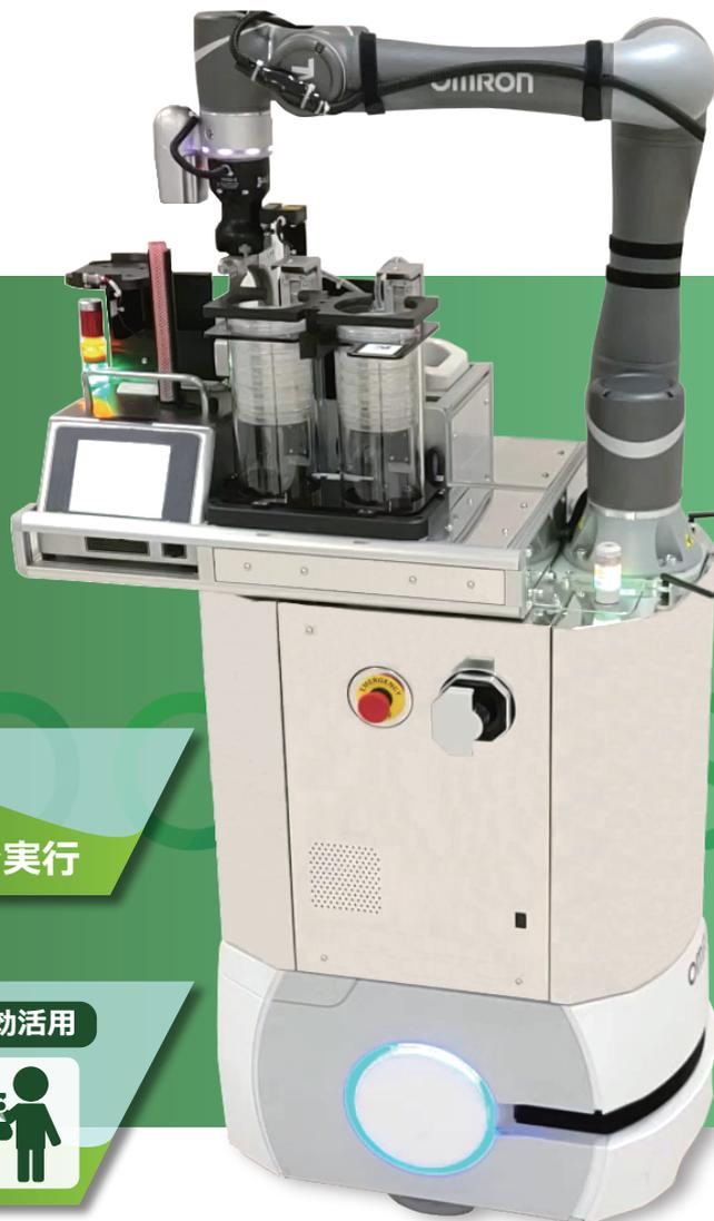
※写真: 搭載協働ロボット TM5M-900
