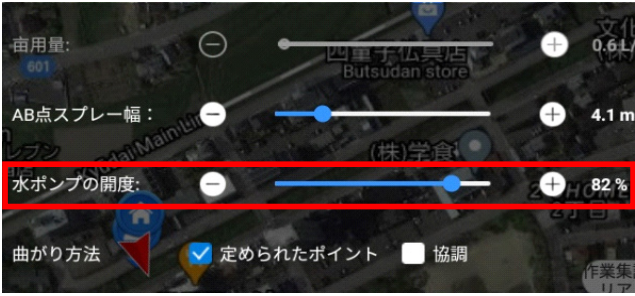
タブレット側ポンプパラメーター
