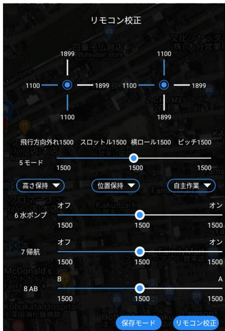
・離陸時にモーターが回らない、着陸時にスロットルを最下点にした場合でもなかなかモーターが止まらない場合に、スティックの校正を行います。
