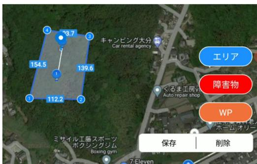
飛行させたいエリアが設定出来たら、次にウェイポイントをタップして、飛行経路を設定します。エリア内をタップすると1から順にウェイポイントが作成されます。完了したら保存をタップします。
