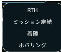
RTH：共通設定にて設定した高度および速度にてホームポイントに帰還し着陸動作を行う。
